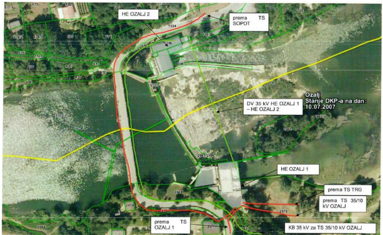
Slika 2.5 Postojeće stanje SN kabelskih veza
