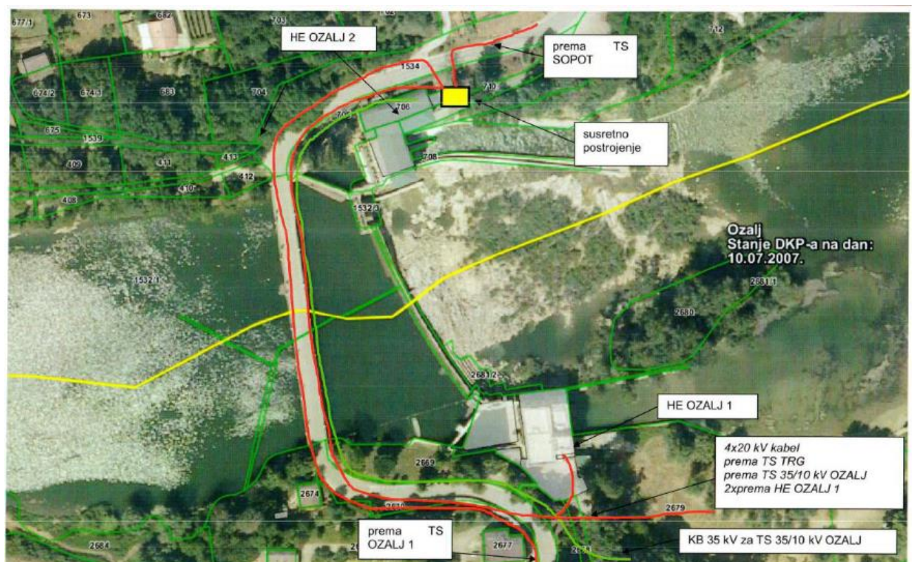
Slika 2.6 Planirano stanje SN kabelskih veza
